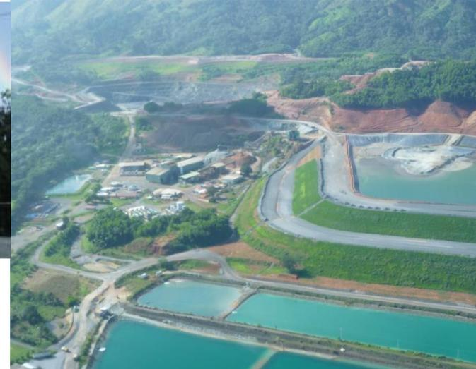
**Sistema de gestión de aguas en la mina Cerro Maimón, consistente en captación de agua de lluvia, almacenado, reciclaje, tratamiento y descarga**
